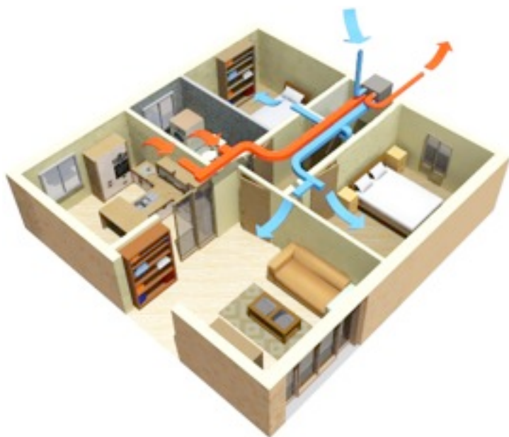
fig.1.1 schema semplificato di funzionamento ALTAIR
