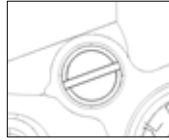
Il By-pass è completamente aperto e consente un ricircolo pari al 50% della portata totale.
