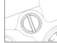
Il By-pass è completamente chiuso e non c'è ricircolo.
