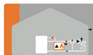
Serbatoio combinato oppure serbatoio buffer con circuito di riscaldamento miscelato con le funzioni aggiuntive bruciatore e pompa del boiler
