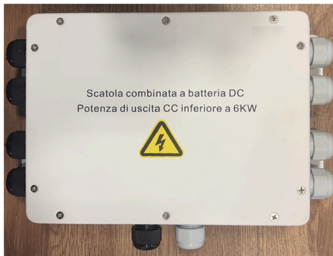
Scatola combinatrice contenente all'interno le barre equipotenziali
