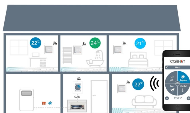
Casa indipendente con termostati °C-Lite Smart, richiesta di energia e cambio di stagione per il riscaldamento/raffreddamento
