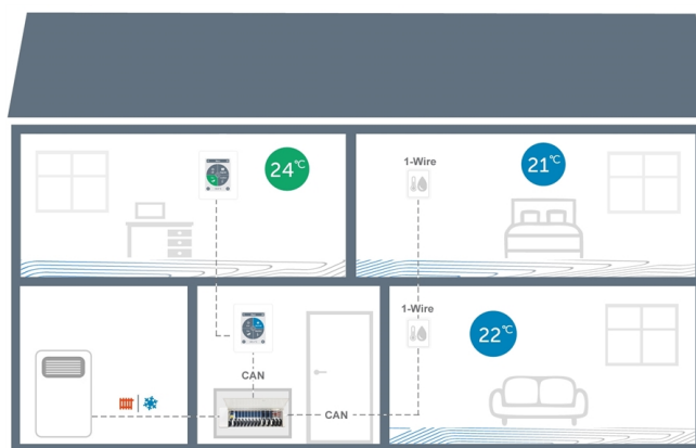
Regolazione multi-zona in una casa monofamiliare, richiesta di energia e cambio stagione di riscaldamento/raffreddamento
