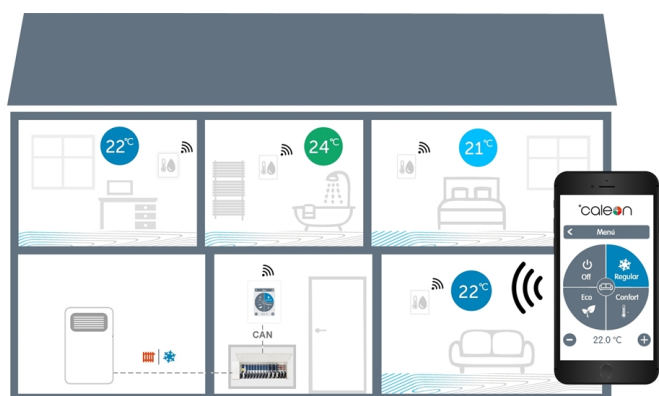
Casa monofamiliare con sensori ambiente WiFi, richiesta di energia e commutatore di stagione per riscaldamento/raffreddamento
