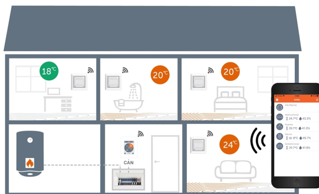
Regolazione di zona in una casa unifamiliare con °CALEON, diverse °C-Lite, WiFi e domanda di riscaldamento.
